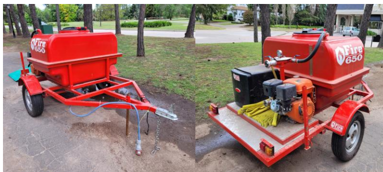
Motobomba, tanque y tráiler.
