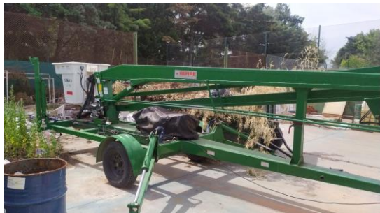
Hidroelevador incorporado al equipamiento del área.
