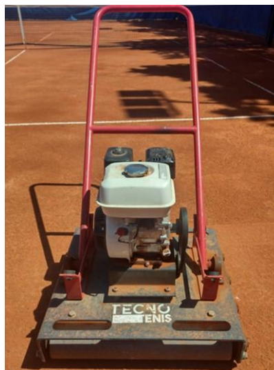
Rolo apisonador para el mantenimiento de superficies de tenis.
